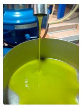
Die Oliven werden etwa 60 Minuten lang zerschlagen und zu einem Brei zerkleinert. Danach werden in einer ganz neuen, hochmodernen Zentrifuge die Öltröpfchen herausgeschleudert und abgefüllt. Herstellung und vor allem die Zwischenlagerung zur Absetzung finden möglichst unter Sauerstoffabschluss statt um schädlichen Oxydation zu vermeiden.
